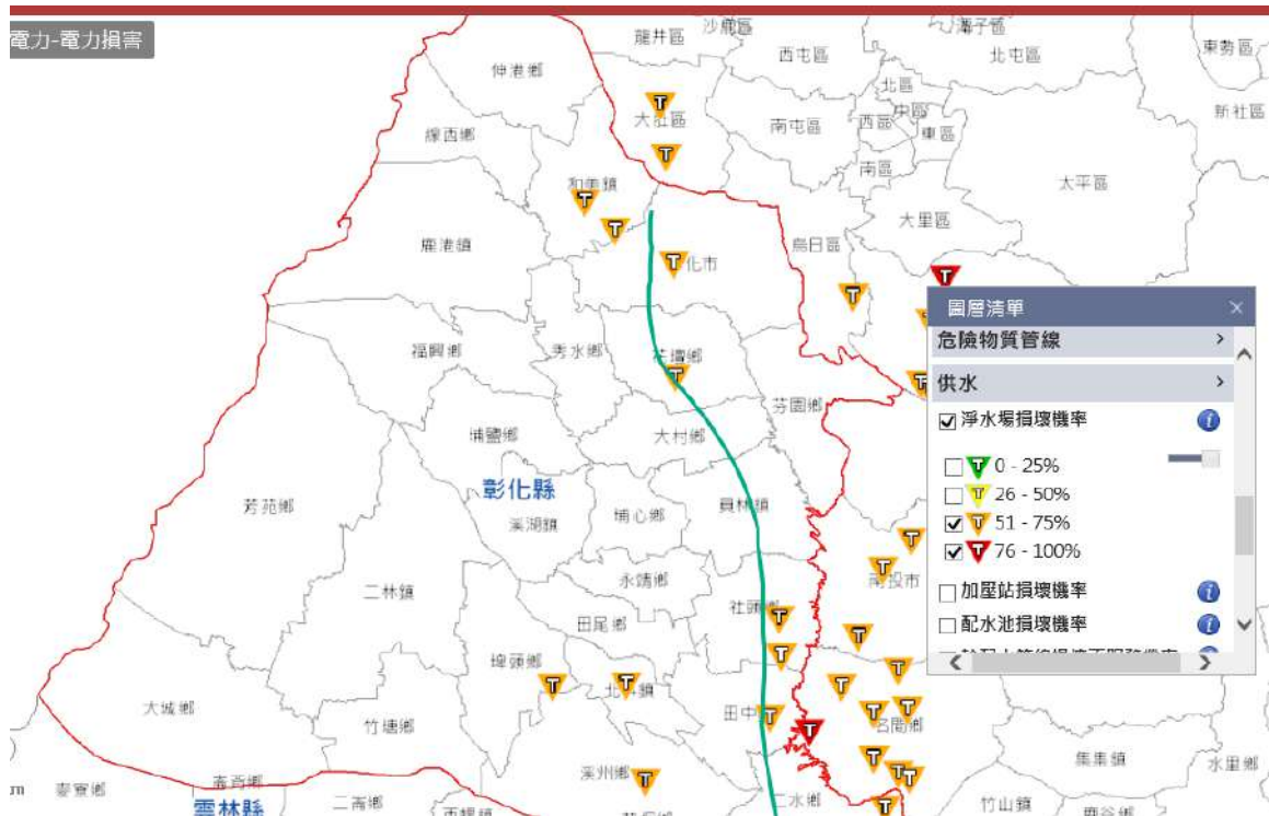
圖 1-3-10 模擬淨水廠損壞機率
